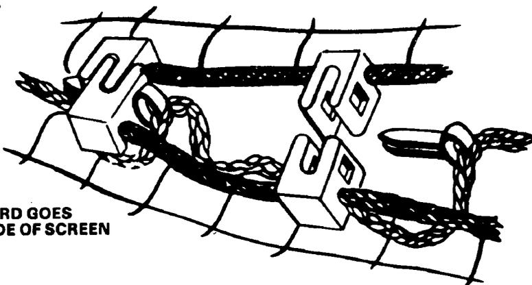
**LANYARD CORD GOES ON UNDERSIDE OF SCREEN**
