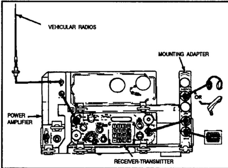
*Figure 4-9. Radio set, AN/VRC-90.*
