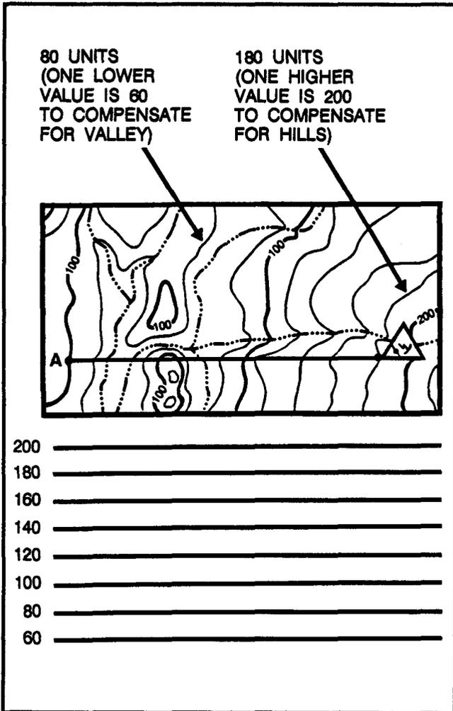
**PERPENDICULAR LINES DROPPED FROM CONTOUR LINES**
